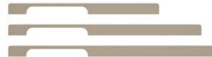
Lavorazione con posizione variabile della zona di presa Machining with variable position of the gripping area
