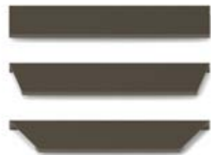
Lavorazione di taglio dritto o inclinato Straight or inclined cutting process
